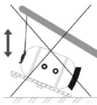
Используйте оба транспортировочных кольца для подъема фильтра из горизонтальное в вертикальное положение
